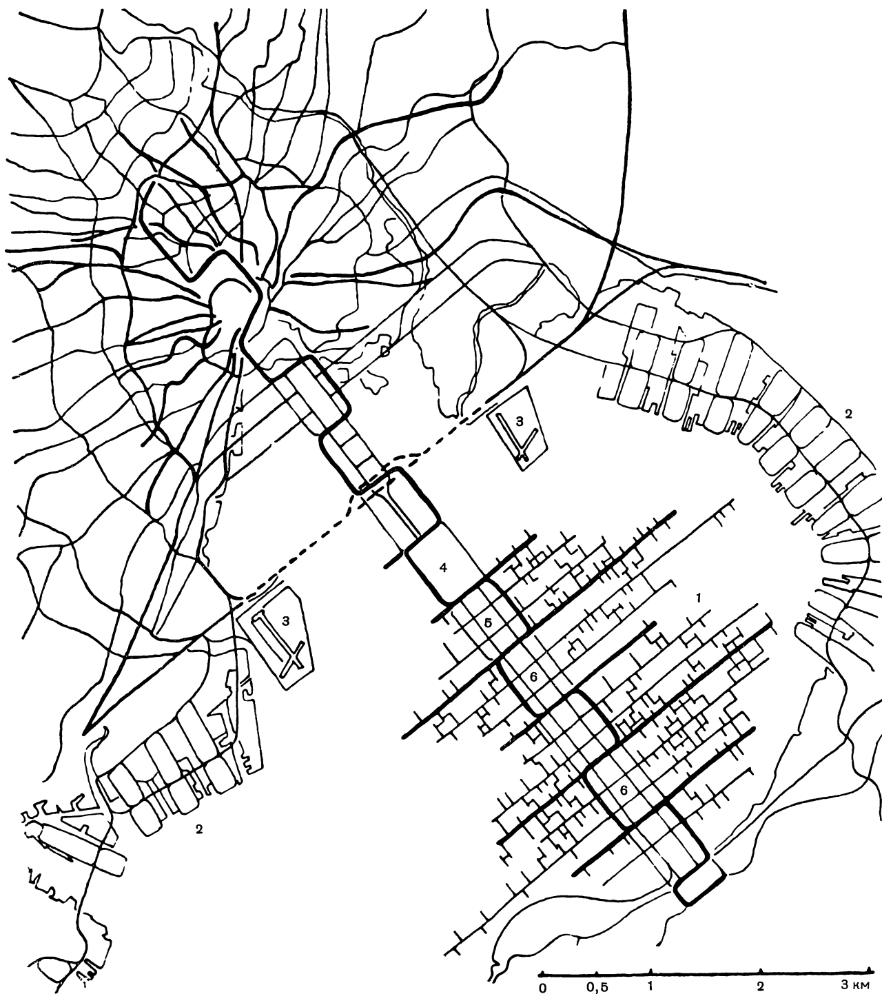
40. Кендзо Танге. Проект расширения Токио; 1959 г. Новый жилой комплекс на 5 млн. жителей сосредоточен в сооружениях, расположенных над морским заливом
